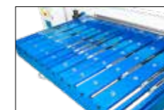
Großer, rechteckiger Auflagetisch im Rückraum mit integrierten Transferkugeln
