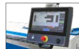
Bedienerfreundliche 15,6" Touchscreen NC-Steuerung an ergonomischen Schwenkarm
